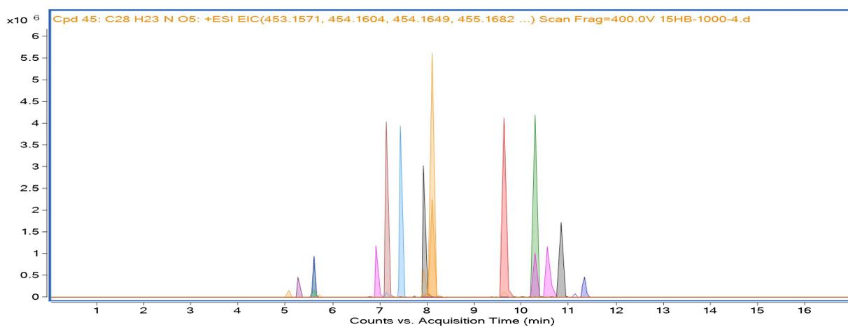
图 C.1 15 种化合物标准溶液 (1  $\mu\text{g}/\text{mL}$ ) 的液相色谱串联高分辨质谱提取离子色谱图
